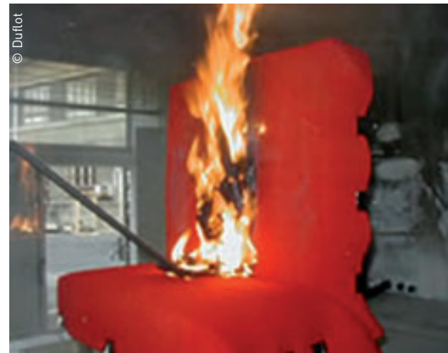
Siège en feu, test sur le matériel chez Duflot
